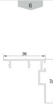
درپوش gap Code : 15321 weight : 0.26 kg/m
